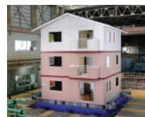
3階建2×4住宅実物大耐震実験 日本ツーバイフォー建築協会の3階建住宅による3次元振動実験より(2006年4月)実験場所:独立行政法人
